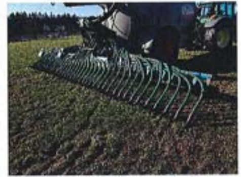
Schleppschuhe: bodennahe Ausbringung, unterhalb der Blattmasse der Gräser ohne Injektion in den Boden; geringere bis keine Verflüchtigung von Ammoniak
