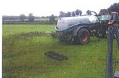
Palette classique: beaucoup de contact entre le lisier et l'air, ce qui augmente la volatilisation
