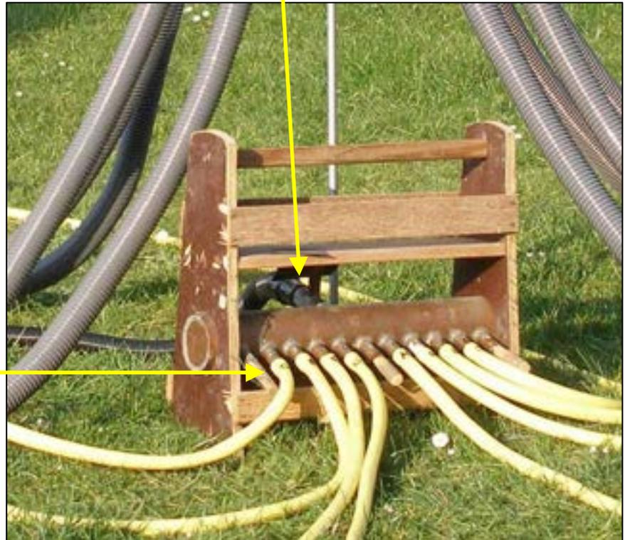
Tuyaux, marqués d'une lettre d'identification, reliés aux différents tunnels et se trouvant en 1<sup>ère</sup>, 2<sup>ème</sup>, 3<sup>ème</sup> ou 4<sup>ème</sup> position par rapport au tuyau central d'aspiration.
