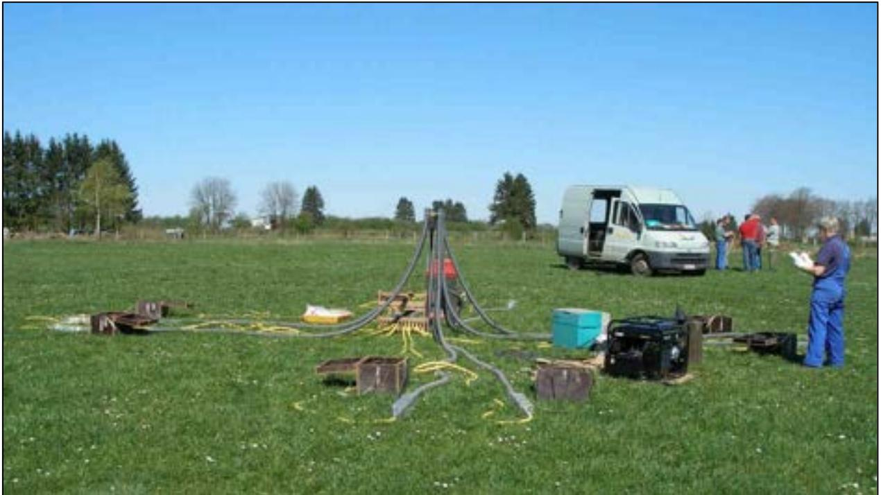
Chacun des 3 entrepreneurs épand d'un côté autour du système de mesure. Il en résulte une répartition en croix, dans laquelle le 4<sup>ème</sup> côté est celui du témoin. Pour ne pas charger inutilement d'ammoniac l'air capté au centre de l'installation, nous veillons à placer à chaque fois le témoin du côté des vents dominants.
