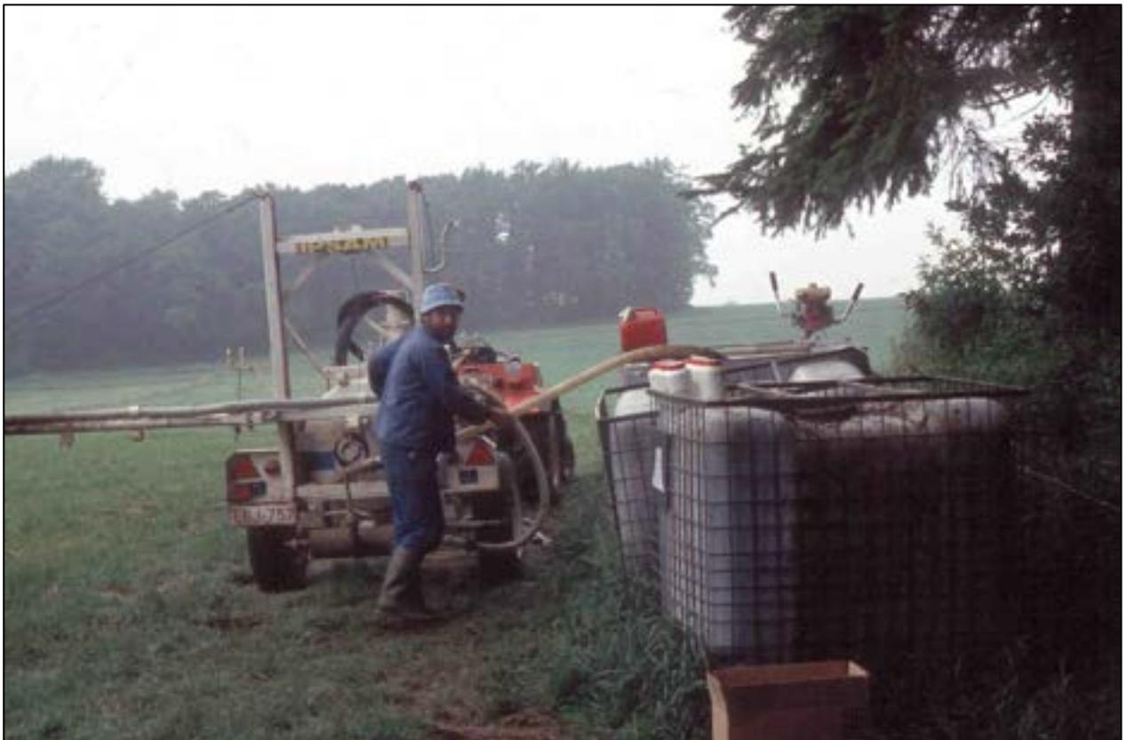
Cette photo illustre le remplissage du tonneau utilisé pour l'épandage en surface : petit tonneau à pression équipé d'une palette inversée, rabattant le lisier au sol après projection. Voir aussi photo p. 21.
