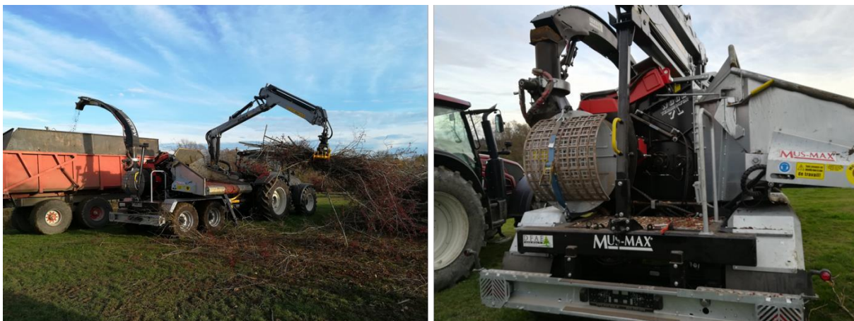
Figure 24. Broyeur à couteaux Mus-Max Wood Terminator 7L (Source : ValBiom / José Harbonnier)
