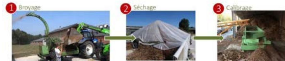
Figure 15. Étapes de transformation des fractions ligneuses des déchets verts en plaquettes combustibles de qualité (Source : Coopeos)
