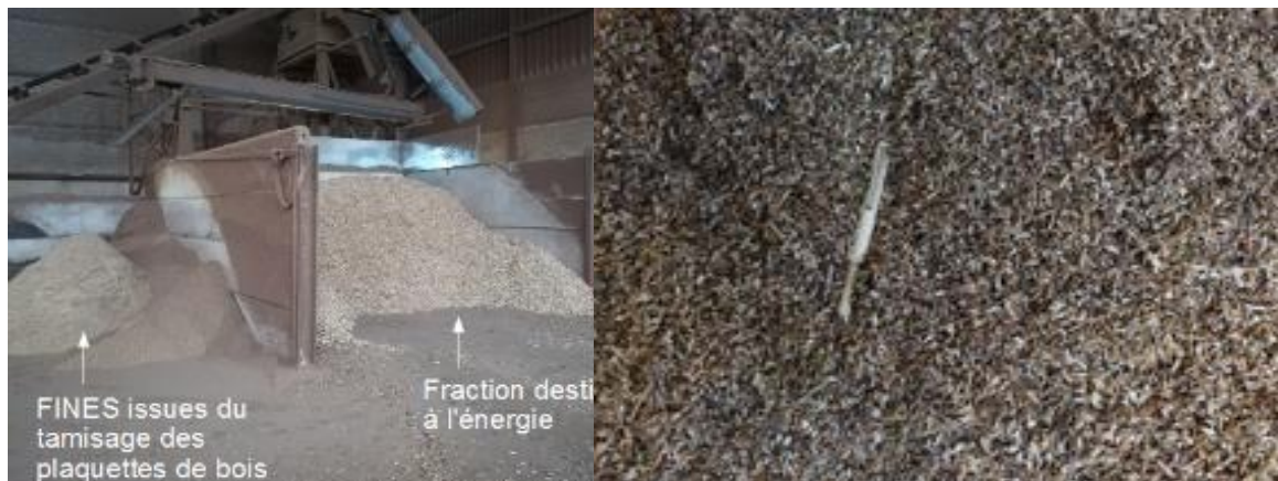
Figure 6 – Fines sèches issues du criblage des plaquettes, pouvant être utilisées en paillage animal (Source : ValBiom/ITS-Energy).
