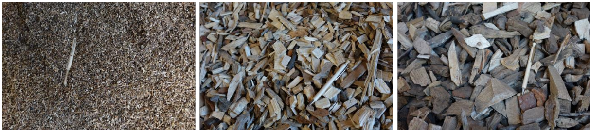
Figure 3. Plaquettes combustibles séchées et criblées en 3 fractions (gauche : fraction fine, centre : granulométrie visée, droite : fraction longue) (Source : ValBiom / ITS-Energy)
