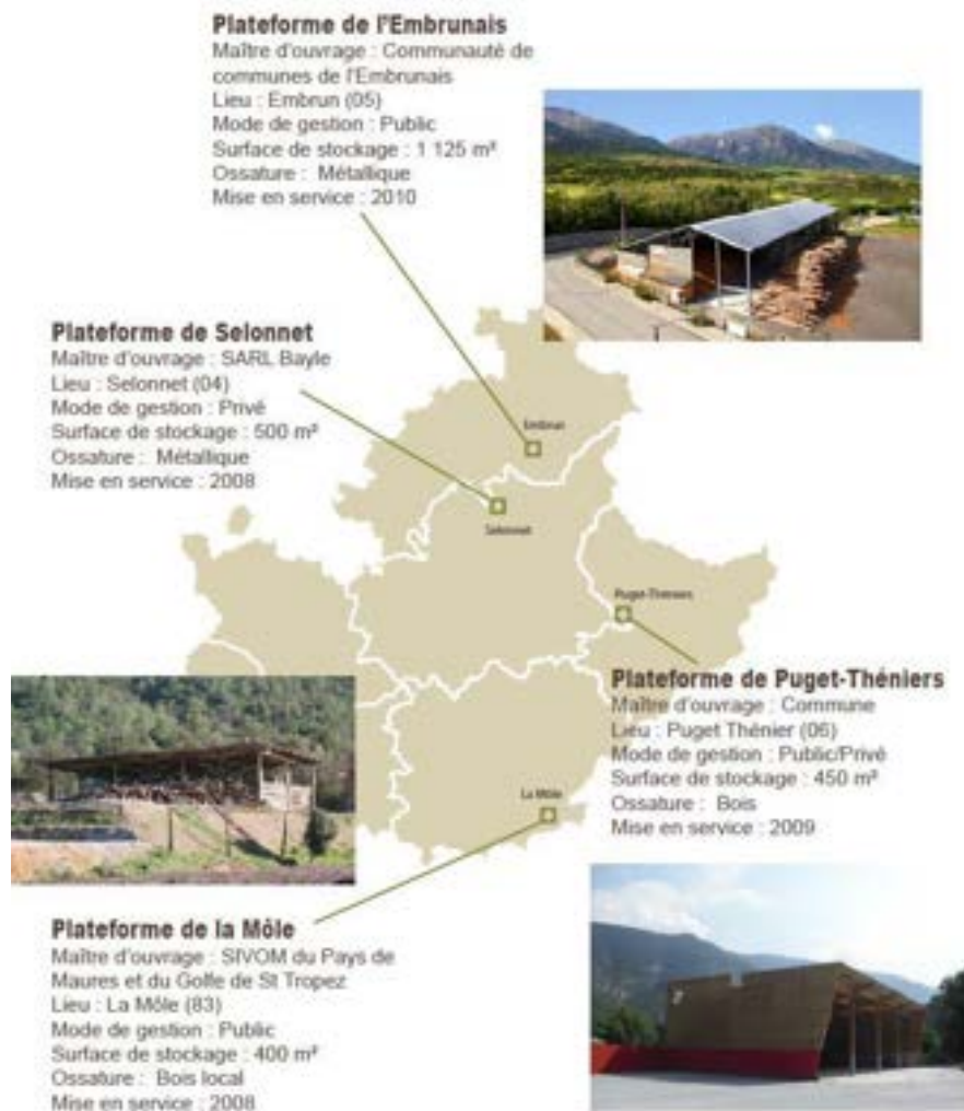
Figure 18 – Réseau de plateformes bois-énergie, gérées localement par le public ou un privé, ou via un partenariat public-privé (Source : http://bois-energie.ofme.org/ ).
