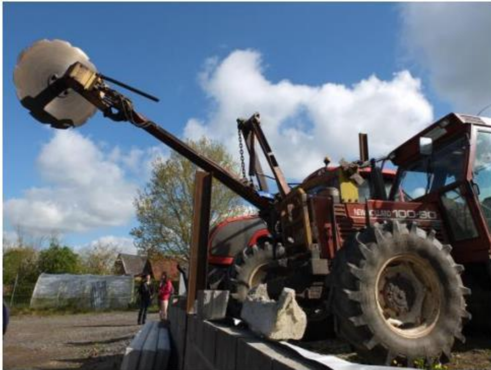
Figure 21. Lamier à scie circulaire utilisé par Mr Harbonnier pour la récolte des tiges de haies (Source : ValBiom)
