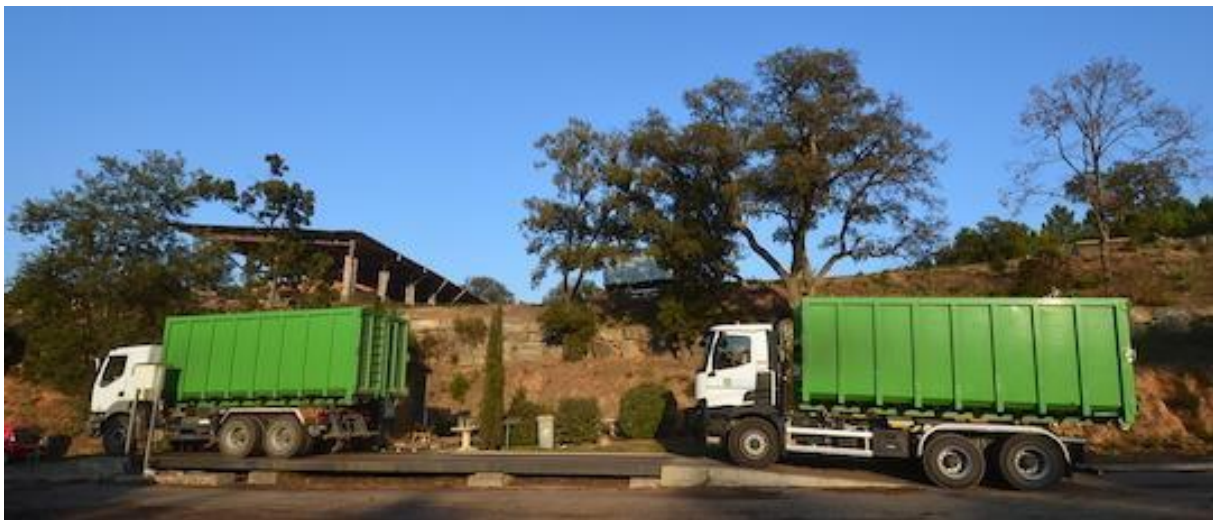
Figure 26. Camions caisson utilisés pour le transport et la livraison des plaquettes (Source : Frédéric Douard / Bioénergie Internationale)
