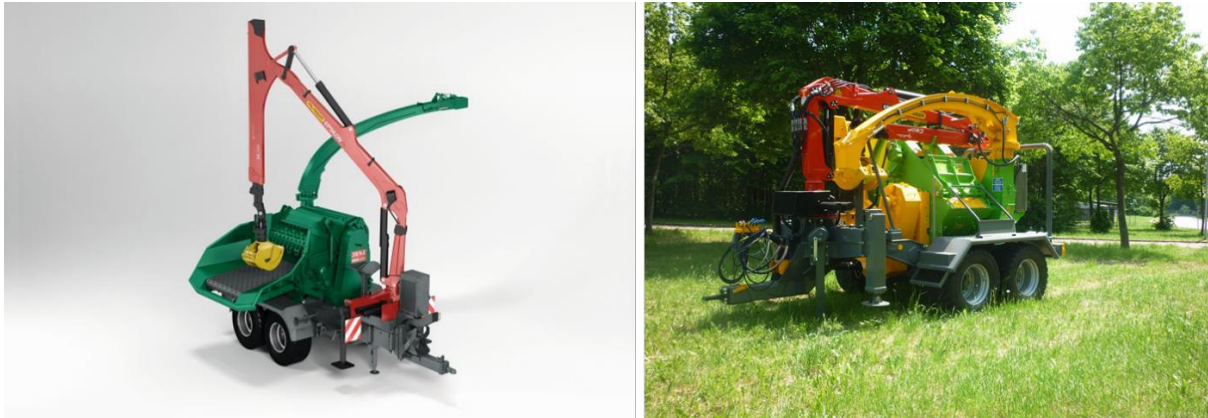
Figure 23. Broyeur à couteaux Jenz HEM 593 Z (gauche) et Heizohack HM 10-500 KTL (droite) (Sources : Van Laecke group / Lectura specs)
