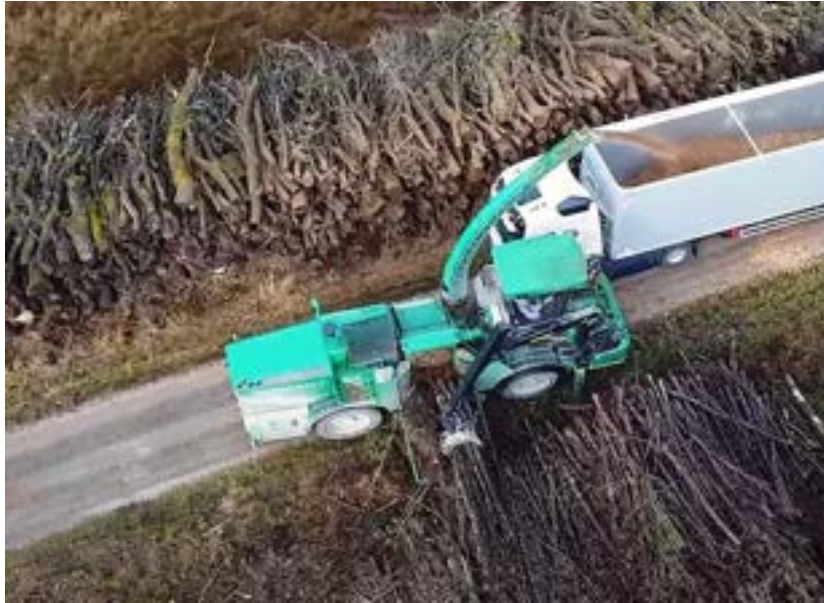
Figure 32. Exemple de chantier de broyage de « bois en bord de route » permettant des gros débits de chantier (Source : Albach Diamant).
