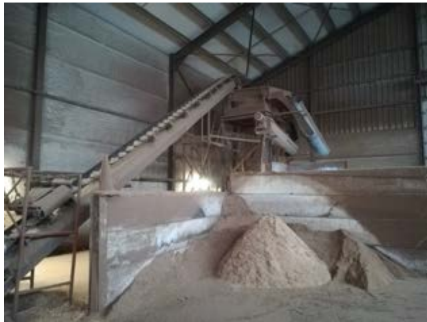
Figure 29. Crible fixe, modèle oscillant à 3 fractions, alimenté par une bande transporteuse directement en sortie de séchoir (Source : ValBiom ITS-Energy)
