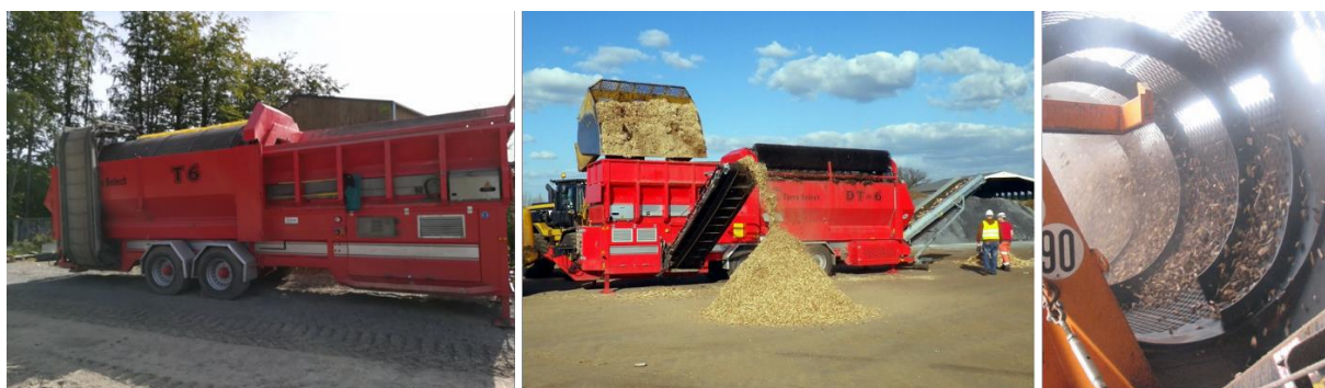
Figure 30. Crible mobile à 2 fractions TerraSelect (Source: ValBiom / Pirothon, Bois-énergie du Maine, FranceEnvironnement)
