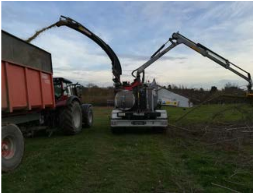
Figure 25. Plaquettes directement envoyées du broyeur à la benne agricole (Source : ValBiom / José Harbonnier)
